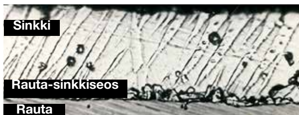
Kuva 5-9. Poikkileikkaus sinkkikerroksesta jatkuvatoimisesti kuumasinkityssä ohutlevyissä.
