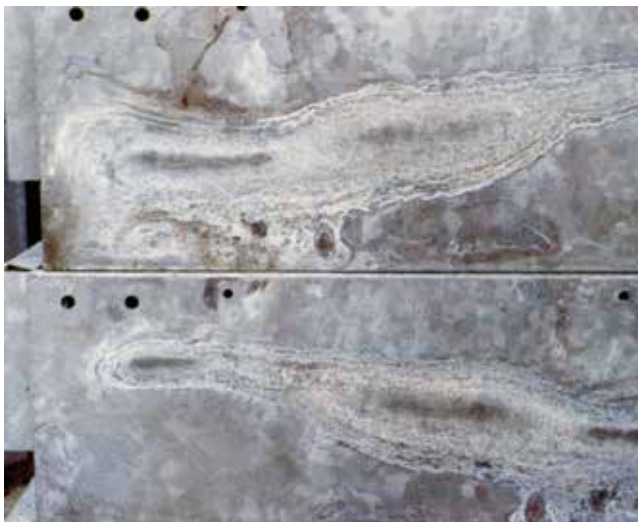
Kuva 10-4. Liian tiiviisti pinottuun materiaaliin syntynyttä valkoruostetta.
