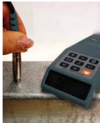
Kuva 9-1. Sinkkikerroksen paksuus mitataan magneettisella menetelmällä.
