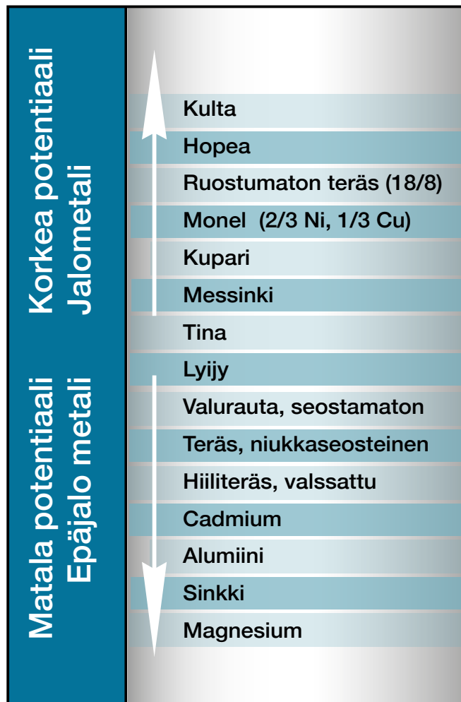
Kuva 10-10. Galvaaninen jännitesarja merivedessä 25 °C lämpötilassa.
