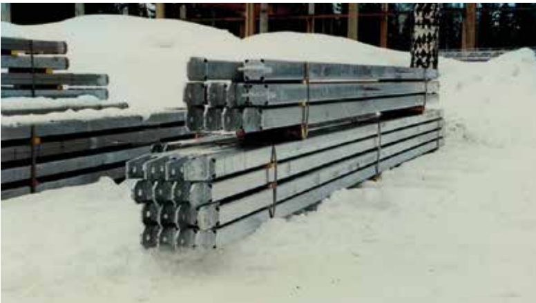
Kuva 10-16. Kuumasinkittyjä tuotteita valmiina toimitettavaksi asiakkaalle.
