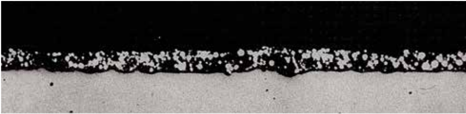
Kuva 3-4. Poikkileikkaus sinkkipölymaalatusta pinnoitteesta.
